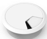
**Sistema de electrificación circular** para el paso del cableado desde el suelo hasta el sobre. La estructura tiene un diámetro de 70 mm con una altura total de 23 mm.
