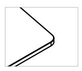
La belleza de las mesas M4 aumentan con la posibilidad de redondear sus bordes. Se configura mediante el redondeo de radio 100° en todas sus esquinas, canteada de PVC con 2 mm. Este pequeño detalle hace que toda la estructura mude su apariencia y transmita un aire amable a la par que moderno, caracterizándose por su continuidad infinita sin ángulos de 90° adquiriendo suavidad y elegancia visual.
