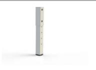
Sistema de regulación mediante patas regulables en altura. Está compuesta de un tubo interno y externo de 50x50 mm y 45x45 mm respectivamente. Fijación mediante doble tornillo visto.
