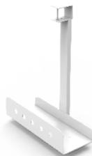
El **porta CPU** es un producto fabricado en chapa de acero laminado en frío con 1.5 mm de espesor. Regulable en anchura (210 mm - 150 mm) con un sistema de ranuras y fijación mediante tornillos.
